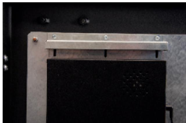
Wenn die S-Box abgesetzt betrieben wird, müssen alle Kabel durch die Bürstenleiste nach innen geführt werden. Das Netzteil der S-Box kann hierzu von der Montageplatte gelöst werden (mit Klettband befestigt).
